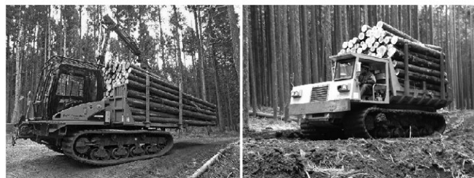
生産性を高める10t積フォワーダ集材 持続的経営林内の防災水源涵養路網における木材搬出 39
