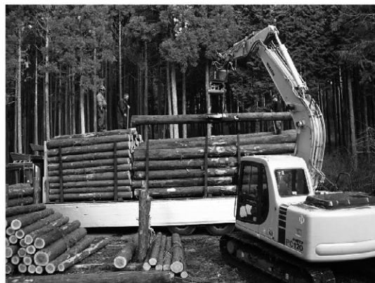
生産性を高める10t積フォワーダ集材 持続的経営林内の防災水源涵養路網における木材搬出 39
