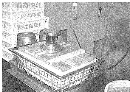
写真6 『脱水』 布袋に入れて加圧式脱水機 で脱水
