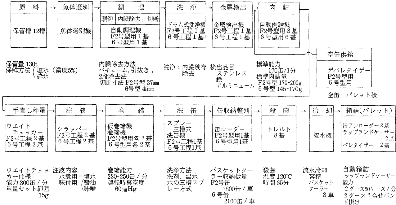
第2図 さば水煮缶詰製造工程図
