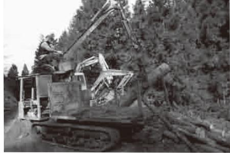
写真5 フォワーダによる間伐材土場おろし作業
