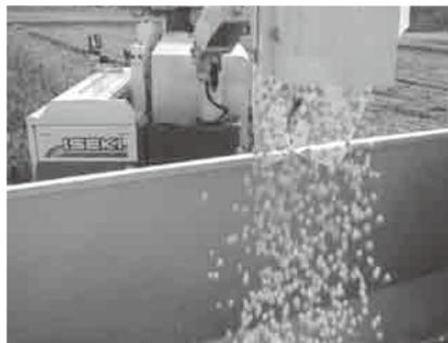
写真5 エアグレン機能を有しているコンバインでの刈取
