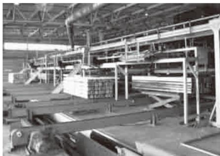
写真4 柱材の重量選別
