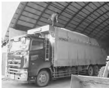
写真3 自動搬出装置付のオガクズ運搬専用車
