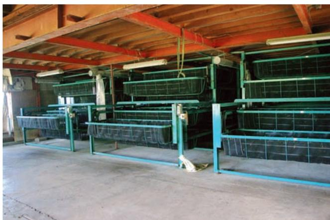
写真2 壮蚕用自動飼育装置(ボンビックス)を3台導入した蚕室
