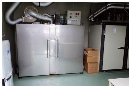
写真3 パウダー化する設備(乾燥機)
