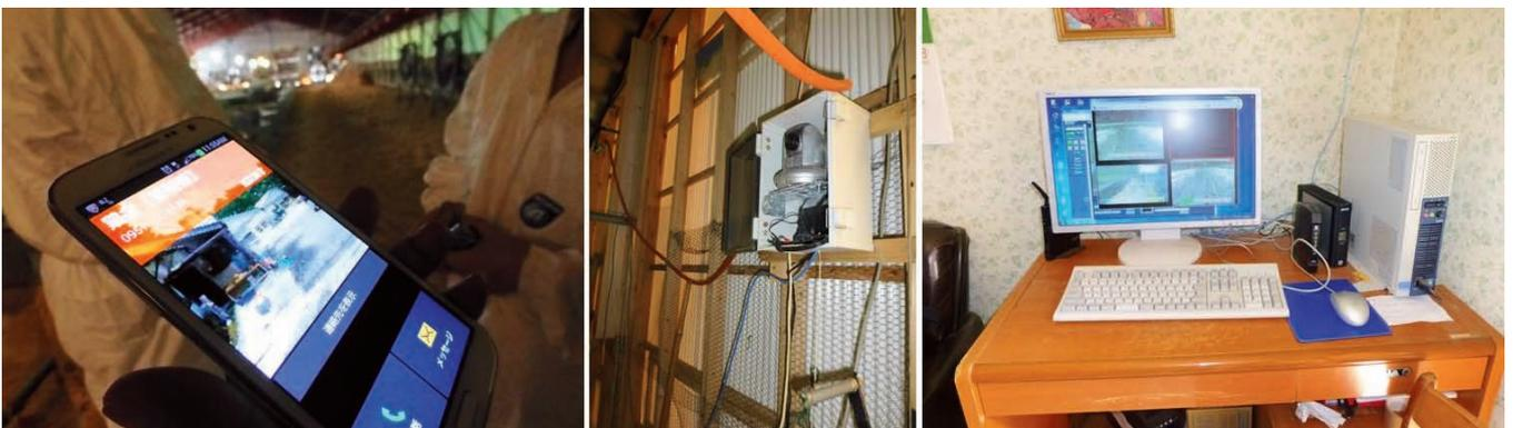
写真1 ライブカメラ(中央)、スマートフォン、パソコンによる鶏舎の管理
