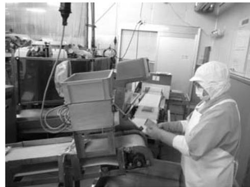
写真10 秤量機・金属探知機
