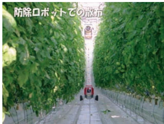
写真7 防除ロボットによる薬剤散布
