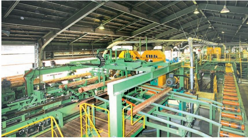
写真4 ノーマンツインバンドソー（第一工場）
