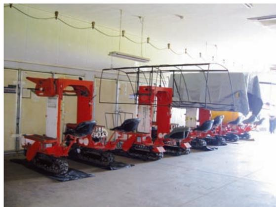
写真3 葉たばこ専用高架型作業機
