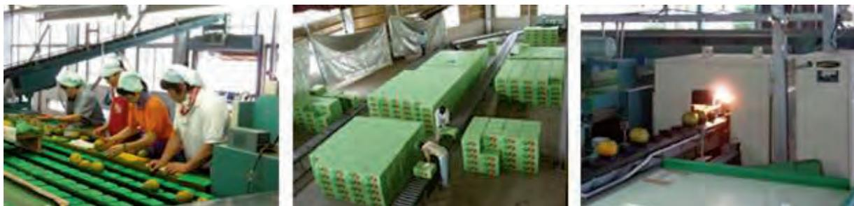
写真8 光センサーによる選果
