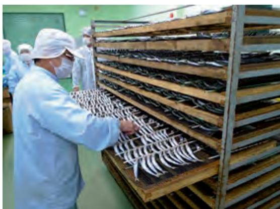
写真5 乾燥棚から製品の取出し
