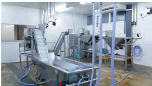
写真2 滅菌海水洗浄(装置)
