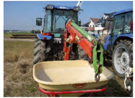
写真1 小野田氏自作のクレーン付き土改材散布機
