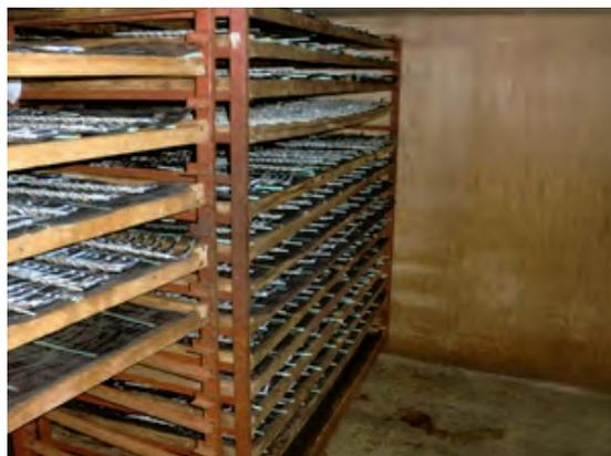
写真4 冷風乾燥機内部
