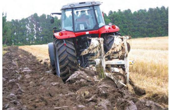
写真3 大型トラクターによるプラウ作業
