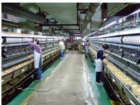
写真4 自動繰糸機による生糸づくり
