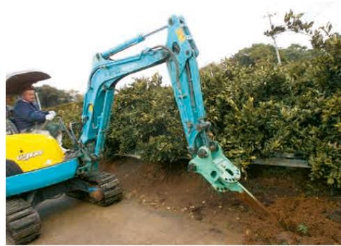
写真2 させぼ温州の断根処理
