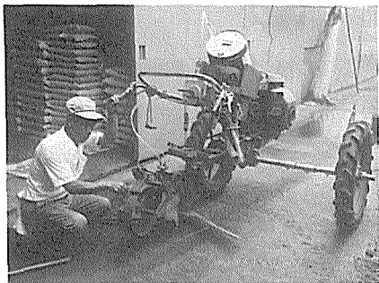
根切虫防除用薬剤散布装置を装着した根切機
