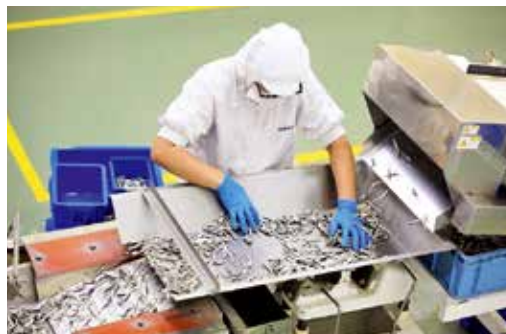
写真1 異物除去工程
