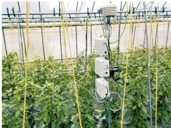
写真13 ハウス内に設置されたモニタリングポスト
