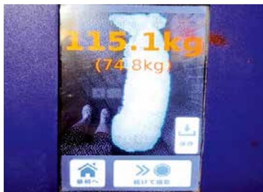
写真2 デジタル目勘体重測定カメラ
