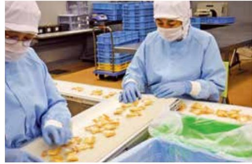
写真4 個包装状態を目視で確認する様子
