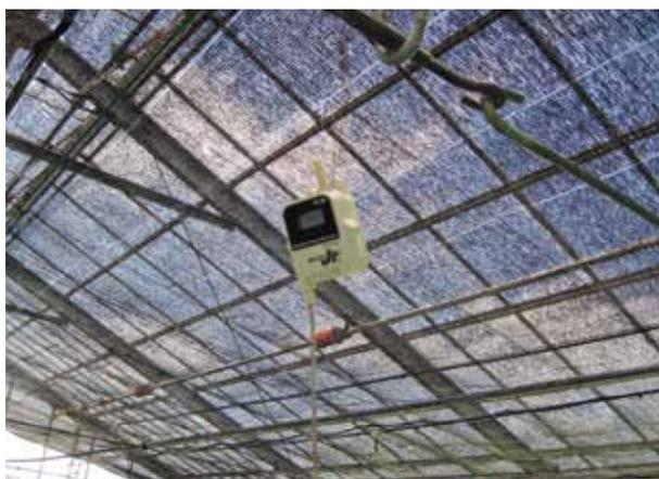
写真16 データロガーの設置状況
