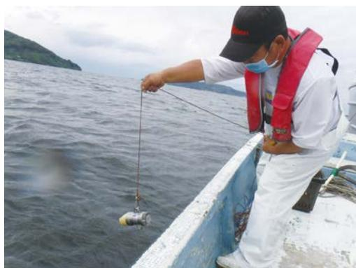
写真1 漁業者によるCTDを用いた測定
